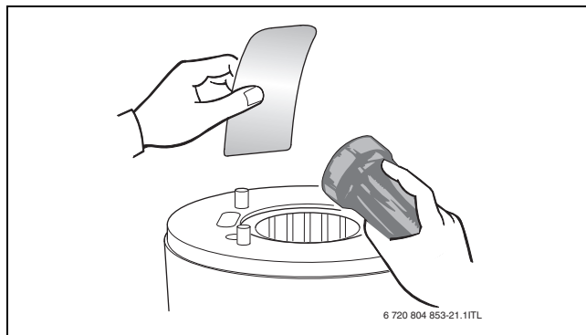
Мал. 63 Перевірка котлового блоку, який включає камеру згорання і теплообмінник, на наявність відкладень
