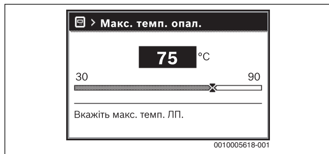
Мал. 25 Встановлення максимальної температури лінії подачі
