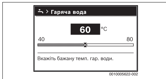
Мал. 27 Налаштування максимальної температури гарячої води
