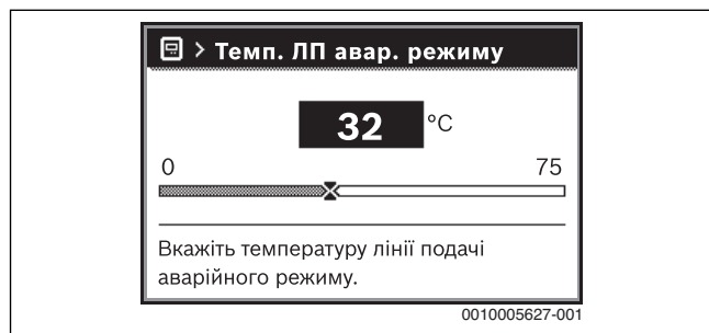
Мал. 42 Температура лінії подачі для аварійного режиму
