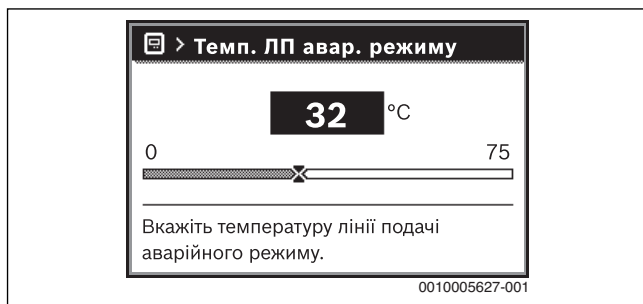
Мал. 30 Температура лінії подачі для аварійного режиму
